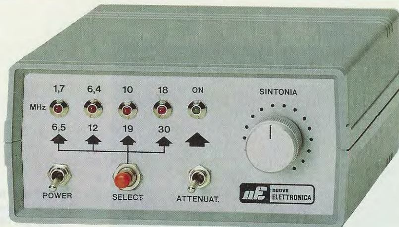
Fig.4 In questa foto possiamo vedere l'esiguo numero dei comandi presenti sul pannello frontale della centralina.
