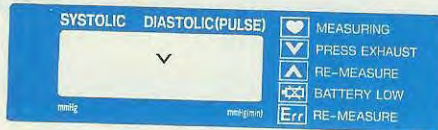
Fig.18 Se durante la misura vi appare ERR significa che l'apparecchio non è riuscito a rilevare la vostra pressione. Il difetto può essere dovuto alla fascia non collocata nel punto giusto, o non fissata con il fermo a "strappo". Se vi appare una "V" non avete pompato tanto da superare il numero 170. Se vi appare il simbolo delle pile con una X, le dovrete sostituire perchè sono scariche.
