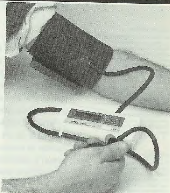
Fig.2 Bloccata la fascia con le due superfici a "strappo", sarà sufficiente pompare fino a far apparire un numero maggiore di 170. A questo punto cessate di pompare e dopo pochi secondi sul display vi appariranno i dati richiesti.
