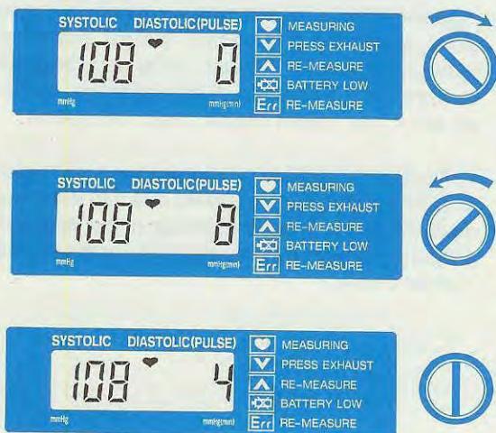
Fig.21 La vite posta sul pulsante della pompetta, la PRIMA VOLTA va tarata in modo che si adatti alla pressione atmosferica della zona. Se questa vite non è ben tarata, lo scarico dell'aria nella fascia avviene o troppo lentamente o troppo velocemente. La taratura risulterà perfetta quando apparirà un numero compreso tra 2 a 5 ( vedi fig.20 ).
